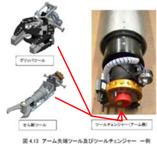
図 4.13 アーム先端ツール及びツールチェンジャー 一例
