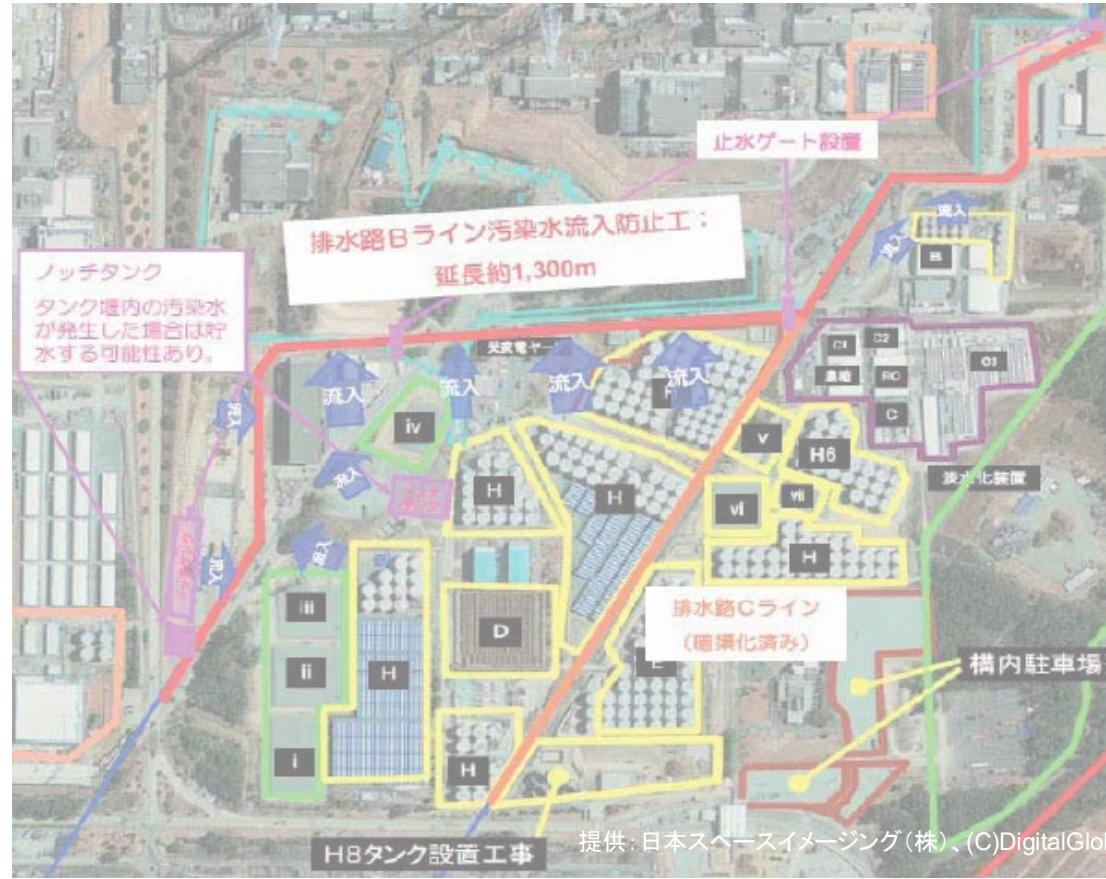
【側溝暗渠化概略図】
