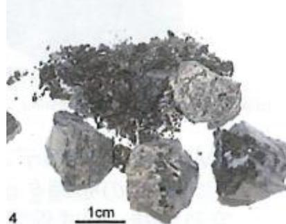
自己崩壊したチェルノブイリの燃料デブリの外観
