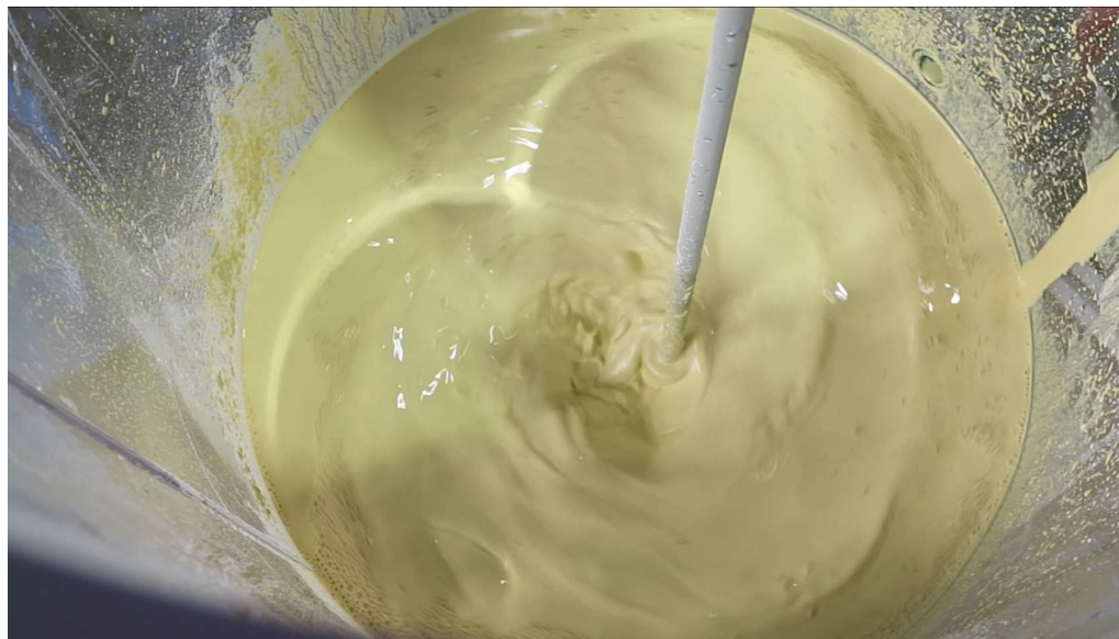
タンク内で模擬物を水と混合しスラリー化
