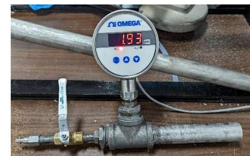
切り出した配管での気密試験
