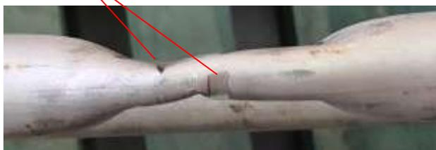
25A Sch80 SUS304配管の圧着を試みた結果
