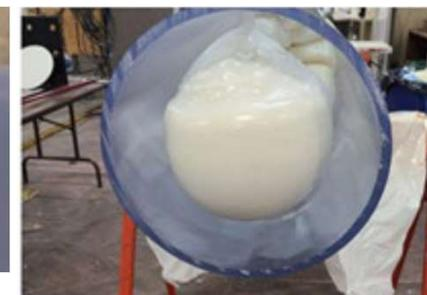
風船による堰の実験（300A配管）
