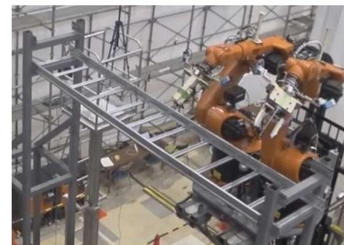
7.専用HMIによる遠隔操作でケーブルトレイを切断
