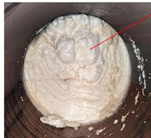
充填材の流動性が低いために不連続な塊状になり、塊と塊の間に隙間が残りがちになる
