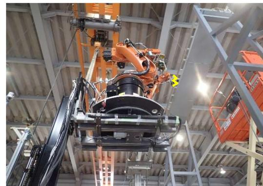
高所での振動確認（レシプロソーでの切断）
