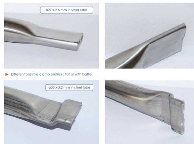
圧着法（小口径配管の系統隔離用）
