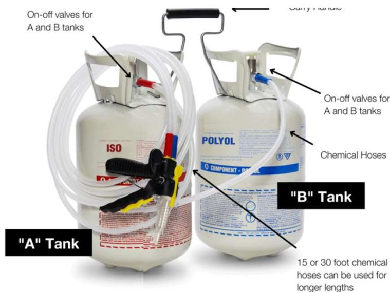
二液式充填材の一例。加圧タンクからそれぞれの液剤が供給され、ノズル先端の混合室で混ざり合いながら放出される。
