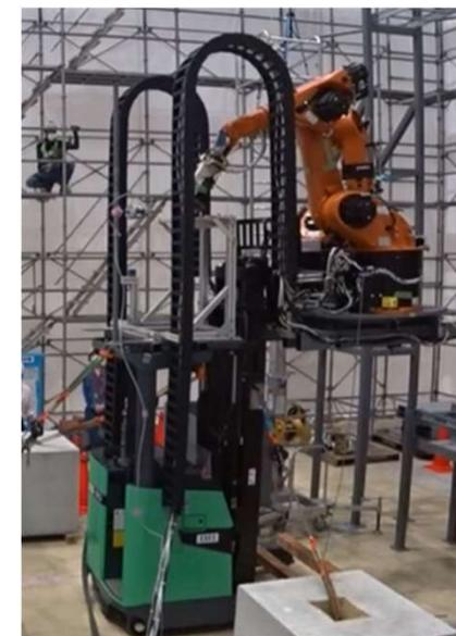
遠隔自動操作による先端ツールの交換
