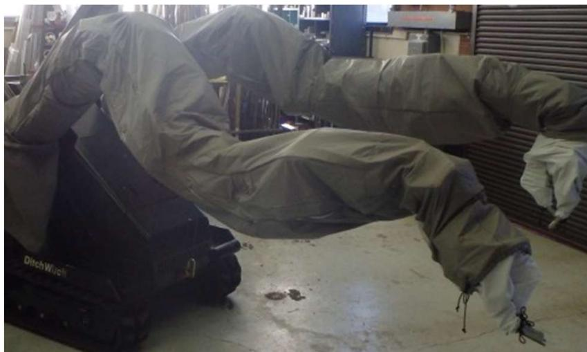
汚染防止カバーをロボットに装着した際の外観例
