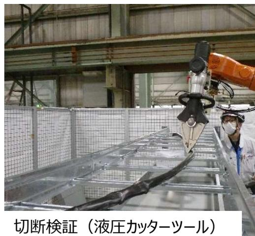
切断検証（液圧カッターツール）
