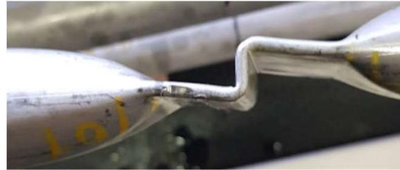
Baffled Jawsで圧着された配管
