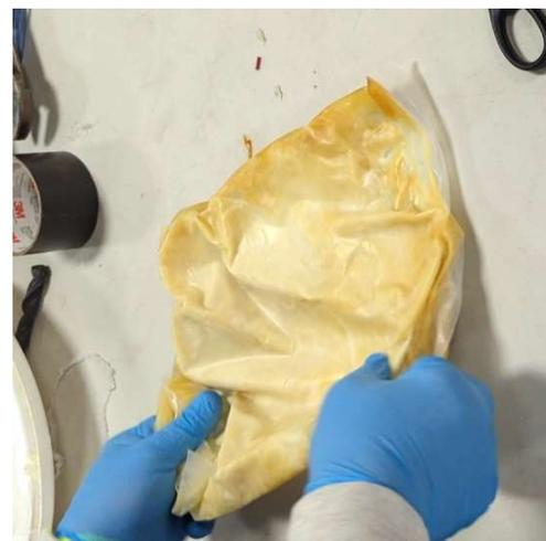
二液式充填材の一例。袋の中でそれぞれの液剤を隔てているシールを引きはがし、手でもみ込んで二液を混ぜてから袋を切り開いて対象に流し込む。
