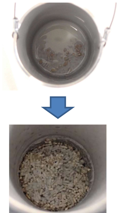
乾燥試験前後の外観 (ゼオライト、水ガラス材5mm相当)
