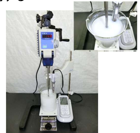
図 凝集剤試験 装置外観
