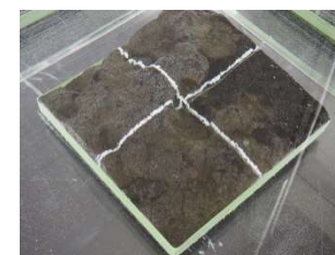
図6 凹凸の大きな燃料デブリに液体→固化タイプの吸収材を使用
