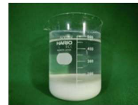
沈殿スラッジの外観
