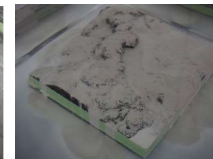
図6 凹凸の大きな燃料デブリに液体→固化タイプの吸収材を使用
