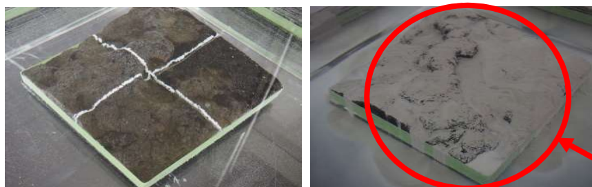
図1 凹凸表面を水ガラス吸収材で覆った例
