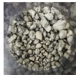
図3 小石状の燃料デブリに液体→固化タイプの吸収材を使用
