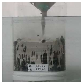
図3 小石状の燃料デブリに液体→固化タイプの吸収材を使用
