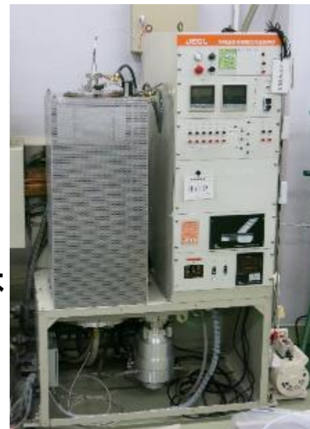
高周波加熱炉 加熱温度 ~2500℃
