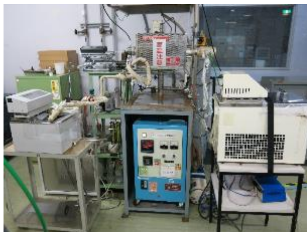
ケラマックス炉 加熱温度 ~1700℃ H 2 /H 2 O雰囲気制御可能
