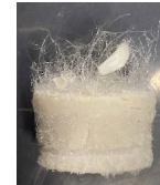
←AAMの白華現象(写真:例)。 Na 2 CO 3 を主成分とする結晶が固化体から析出。
