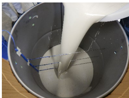
ドラム缶にM+BFS+CSを打設。極めて高流動。 (熱電対に当たって液流が分離するほど流動性が高い。)
