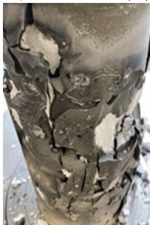
↓横からのCT断面:赤□ ↓圧縮破壊の様子(横)
