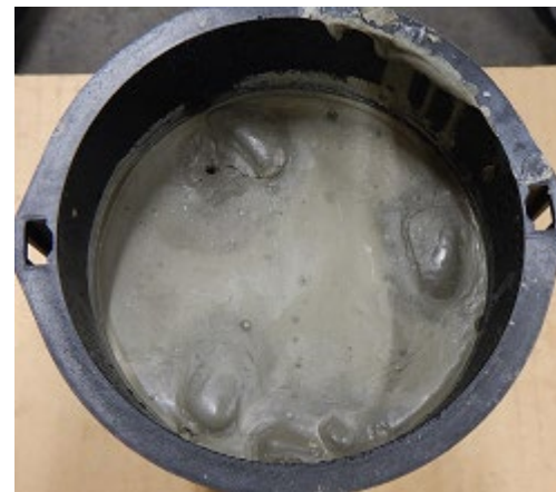
塊状ISの浮上
