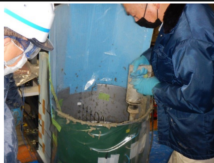
33%打設。硬化が進行。 棒式バイブレータも効果なし。
