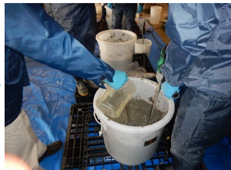
混練開始から 15分 。 流動性確保のため、水3Lを追加*、練り返し。
