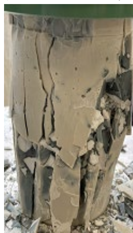
↓横からのCT断面:赤□ ↓圧縮破壊の様子(横)
