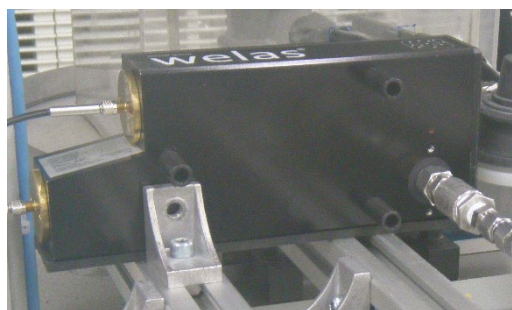
Palas社のWelas2000(左)とPromo2000(右)※ (光散乱径測定、 粒径範囲は0.2~40 \mu m )
