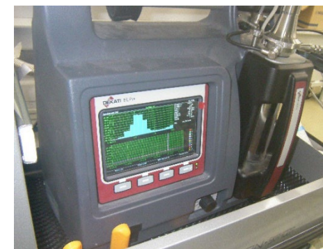
ELPI+(空気動力学径測定、 粒径範囲は0.01~10 \mu m )
