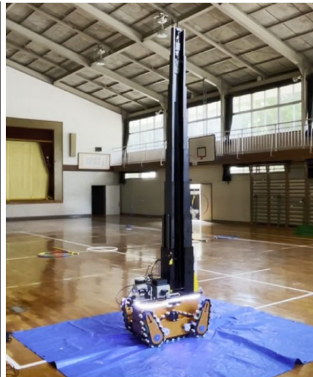
移動・上下伸縮機構の動作実験
