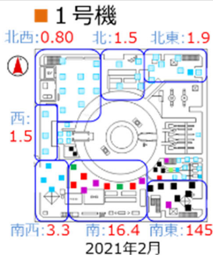
原子炉建屋1階 各エリアの線量率の平均値 (単位 : mSv/h)
