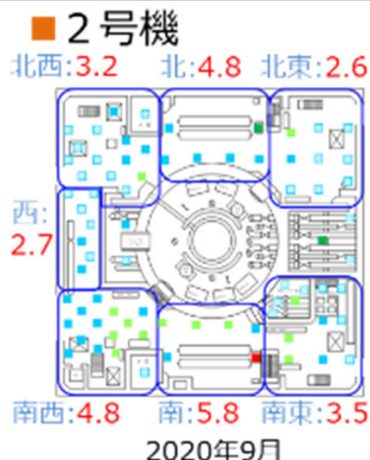
原子炉建屋1階 各エリアの線量率の平均値 (単位 : mSv/h)
