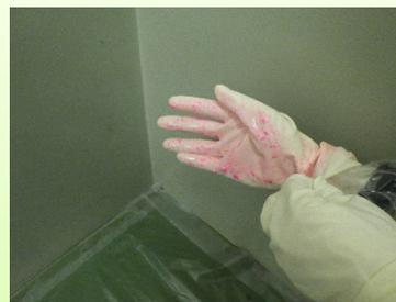
②ゴム手袋を脱装した際の模擬汚染の飛散具合を専用カメラ※2で撮影する。
