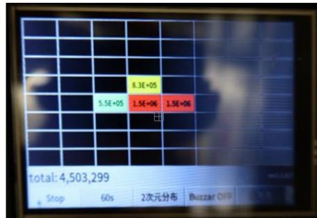
(左)開発した $\alpha$ 位置検出器による脱装前のマスクフィルタ上の $\alpha$ 汚染検査の例。
