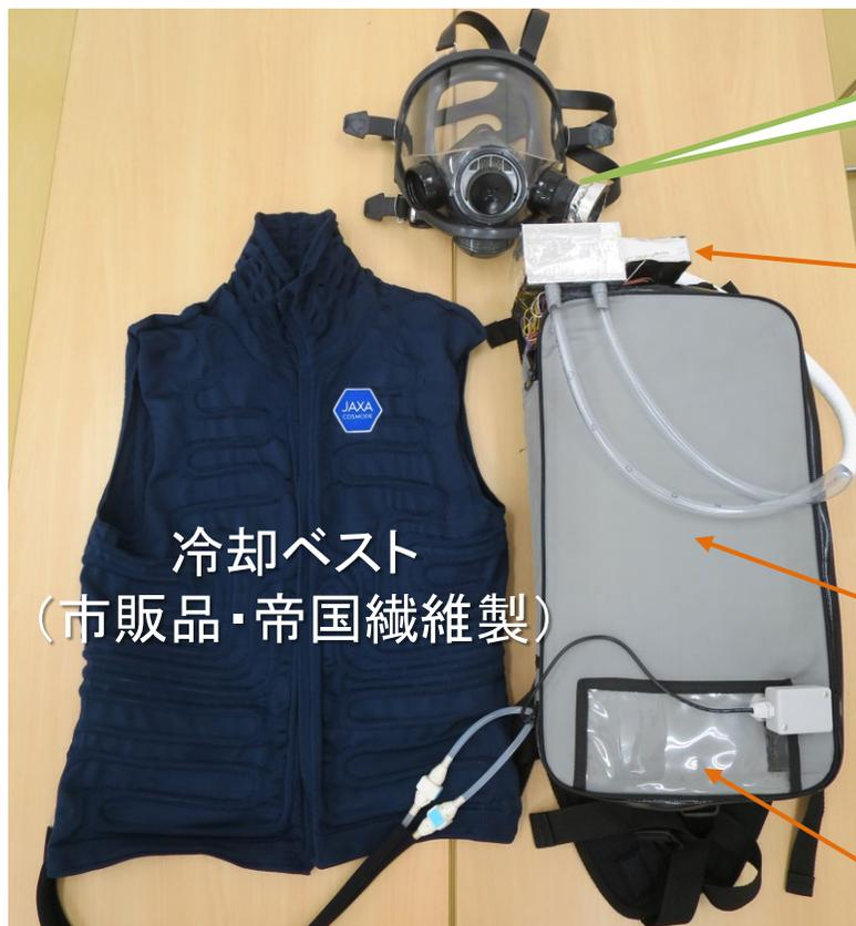
本タスクでは**機能試作**を実施。面体・チューブ接合部に関しては接着剤等による接合とし、抜け防止構造等はタスクの対象外（ただし、手による引っ張りで外れないことは確認済み）
