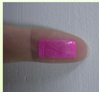
① 指先に模擬汚染として、水性塗料※1又は油性塗料※2を塗布（1.5cm程度の長さで2往復塗布）し、所定の時間放置する。
