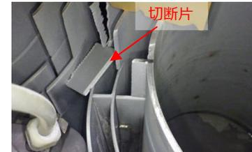
ウォータージェット噴流による切断片吹き飛ばし
