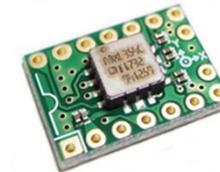
適用するセンサ（加速度センサの一例）
