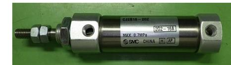
切断片回収治具用シリンダ
