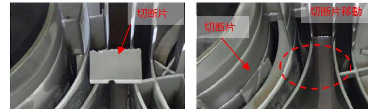
次ステップ切断による切断片の移動
