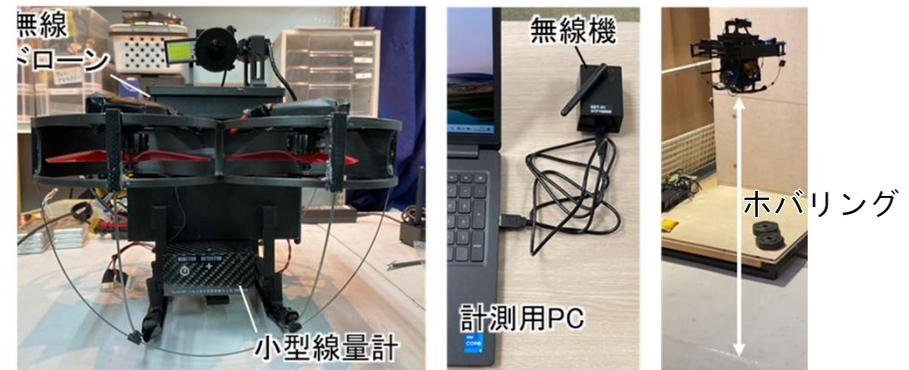
試験時のドローン出力は75% (運用時の想定最大出力)で飛行(ホバリング)させ、ノイズの影響確認試験を実施
