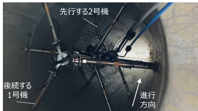
図1 クローラが700A配管の直管を登る様子（配管下側の覗き窓から見上げた図）
