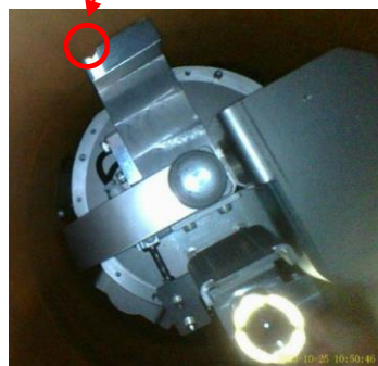
図2. 弁体加工ユニットのスタック状況
