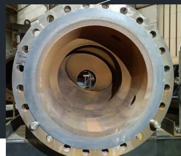
(e)穿孔完了後の内弁体 (PCV側から見た図)
