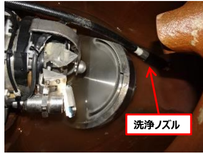
図2 弁体落下状態と洗浄ノズル (解説：弁体後方に堆積したアプレシブを洗浄ユニット（加工装置ノズルと洗浄ノズルを併用）で除去して弁体を弁箱内に落下させ、その後、洗浄ノズルにて弁箱内のアプレシブを除去。)
