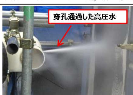
図2 ティA配管穿孔状態 (解説: 200MPaの高圧水を配管内壁部に噴射して、Φ10mm以上の穿孔条件を評価)
