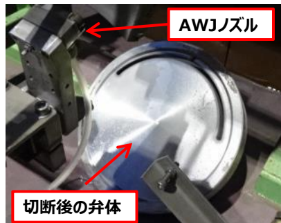
図1 弁体細分化切断前の状態 （解説：モックアップ外で弁体切り落としを実施後、弁体の弁箱内落下状態を模擬して細分化切断評価を実施）
