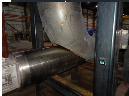
(a)エルボ部への挿入状況 (解説：1F現場では エルボ穿孔部にバウンダリを設ける)
