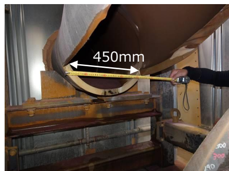
図4 見直した切断軌道によるエルボ開口部外観
