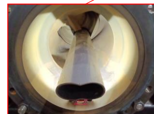
図3-3 内弁穿孔部を 通過した後の様子 （※先端部は図2のような テーパ形状としているため 本写真ではパイプが 歪んで見えるが正常である）
