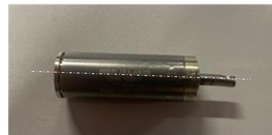
図3 モータ軸の変形の様子
