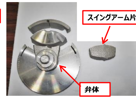
図4 細分化状態（スイングアーム側） （弁体と裏面スイングアームが同時切断できており、次工程アクセス装置への影響は少ないと判断）
