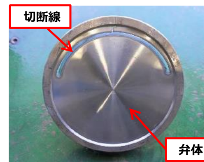
図3 切り落とした弁体（シール面） （解説：切断円弧角：145°を実現できており、細分化できる形状と判断）
