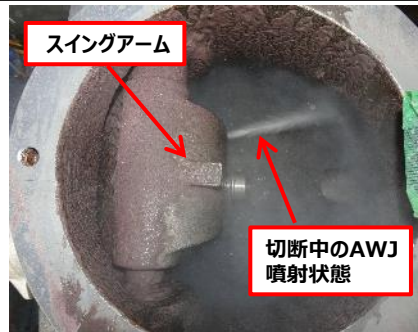
図2 弁体切り落とし試験状況 (解説：逆止弁シール面側から、弁体とスイングアームを同時にAWJで切断加工。)
