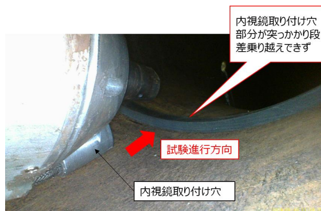
図2 内視鏡取り付け穴部分のスタック直前の様子
