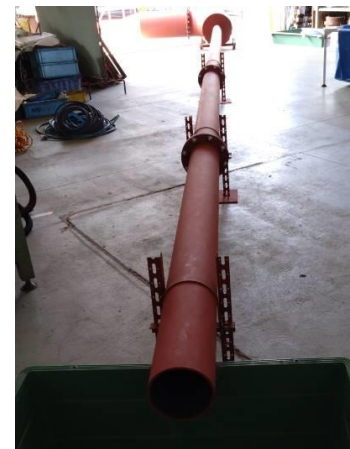
図2 MSIV弁体穿孔部挿入用の形状模擬ガイドパイプ(**)
