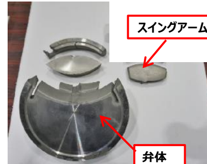
図3 細分化状態（弁体側） （解説：弁体を3分割、スイングアーム片の4つに分割可能）
