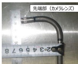
(a) 模擬内視鏡外観 (先端屈曲させた様子)
