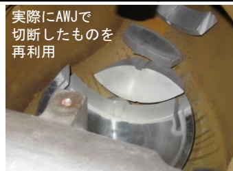
図1 弁体切断試験で切断したピースの落下状態を再現した様子
