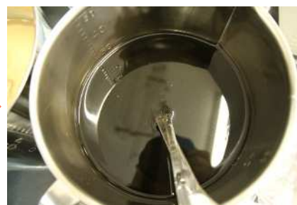
イオン交換水に \text{RuCl}_3 を溶解させ樹脂を浸漬しRuを吸着
