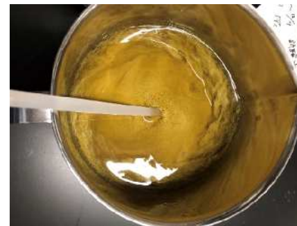
イオン交換水にRuCl 3 を溶解させ樹脂を浸漬しRuを吸着
