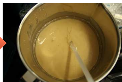
模擬海水中にCoCl 2 を溶解させ樹脂を浸漬しCoを吸着
