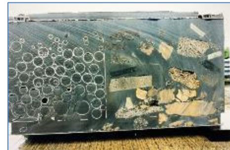
図2 グラウト材充填後のコンテナ断面
