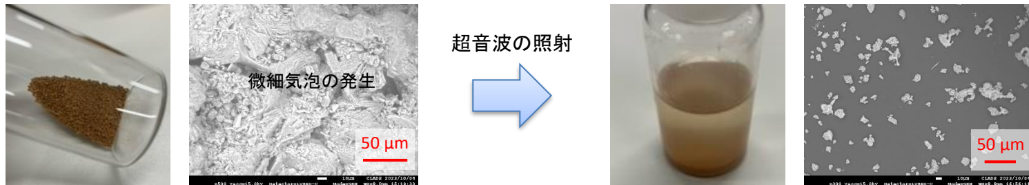
図2 IE96 吸着材の粉砕の様子
