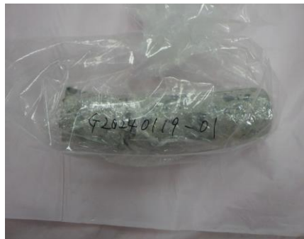
図2 瓦礫試料の例 (3号機Rw/B 1階壁面コンクリートコア)
