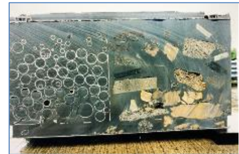
図2 グラウト材充填後のコンテナ断面
