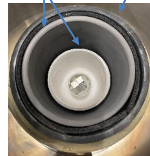
黒鉛るつぼ内の設置状況
