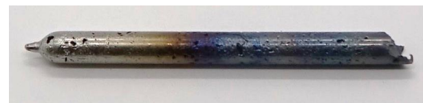
サンプリングしたメタル層試料 (溶融完了後の温度保持時間 2分) 直径約5mm×約60mm長
