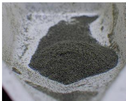
図2 乾燥後のフェロシアン化ニッケルカリウム
