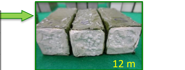
図2 AAM(M)固化体の暴露面の状況(加速条件)
