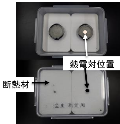
図1 断熱材を用いた温度測定の様子
