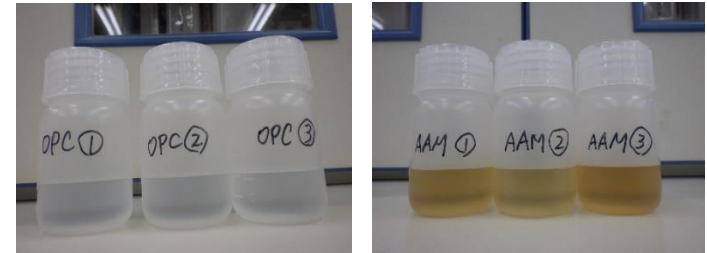
図1 回収したろ液(左:セメント固化体、右:AAM(M)固化体)
