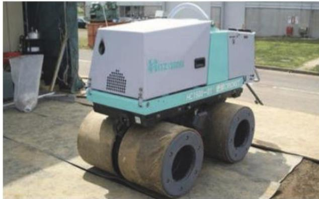
写真4 小型振動ローラ (1.5t級)
