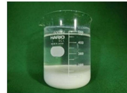
図2 沈殿スラッジの外観
