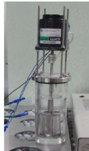
図2 吸着速度試験装置 (電中研保有試験装置)
