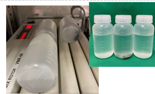
(b) ローラー振とう式の吸着速度試験 （HOT試験（Am試験））
