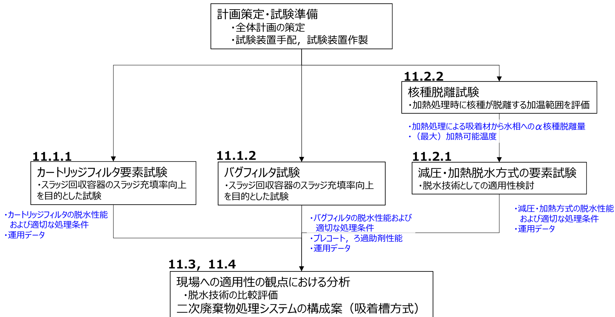
図 スラッジ脱水技術の要素試験計画の流れ
