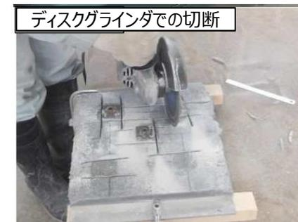
一般的な加工ツールによる加工状況
