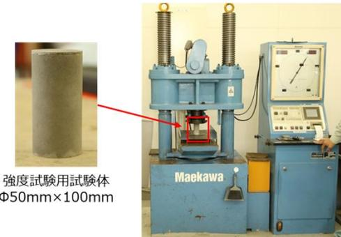
強度試験用試験体
