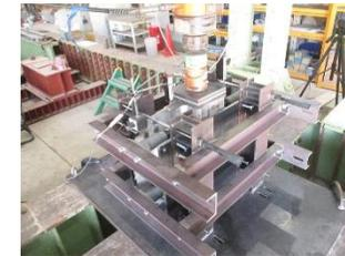
No.1 気中吹付施工試験 (載荷)
