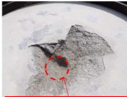
落下物模擬体の先端部が衝突した痕跡
