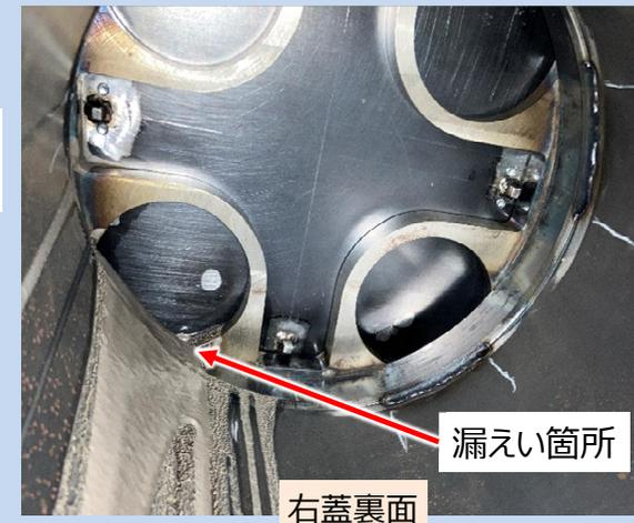
堰内から充填材が漏えいしたものの、充填材が徐々に固化し最終的に堰内280mm高さまで充填材が残存した。
