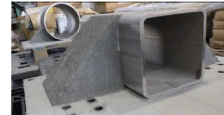
No.1 気中吹付施工試験 (試験体)
