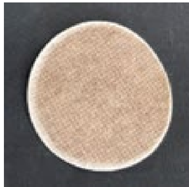
実際のろ紙付着物の状態 付着物量：0.22 mg/cm 2
