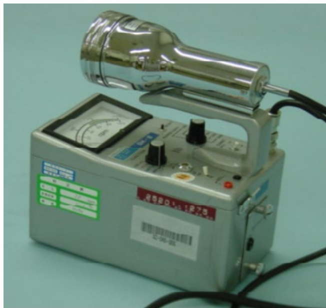
既存の \beta 線用サーベイメータ (GM管式)
