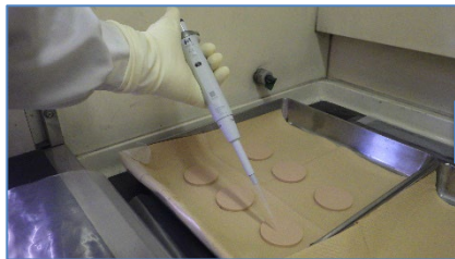
① 人工皮膚に溶液を滴下 (静置時間：40分間)
