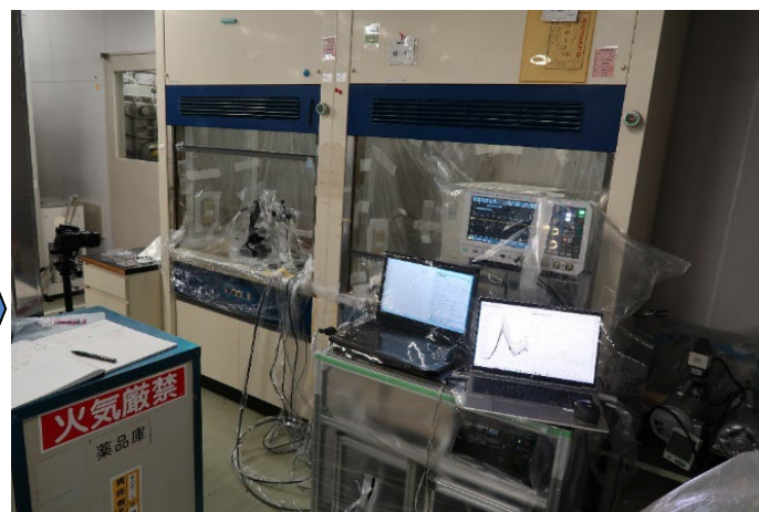
核燃料物質取り扱いフード
