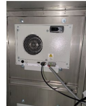
放水後の内部写真 （水の侵入なし）
