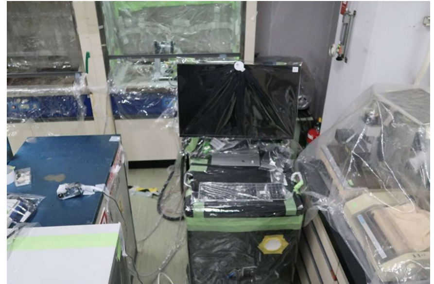
フード横に設置した可搬型マイクロ波 重畳LIBSシステム
