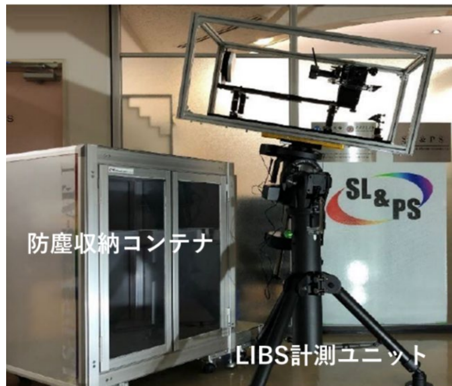
粉塵環境対応防塵収納コンテナへの設置例
