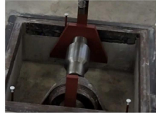
⑪ラグ開口位置へラグピン挿入
