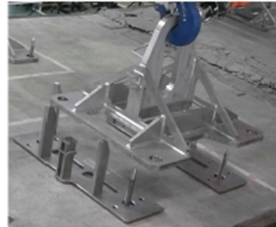
ロボットアームの位置を、新規ラグが概ねアンカーボルトの直上に来る位置に移動
