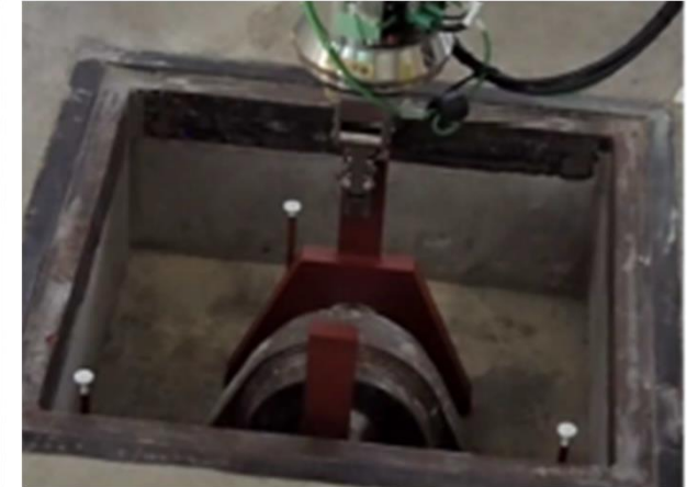
⑪ラグ開口位置へラグピン挿入
