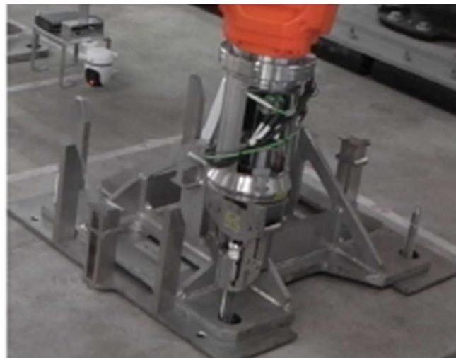
固定用ナットにて新規ラグ固定(グリッパツール)(1)
