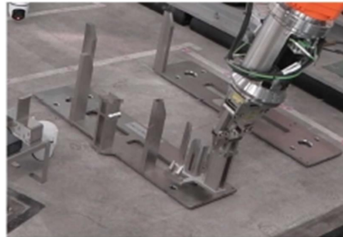
カプセル投入用のガイド設置 (2)
