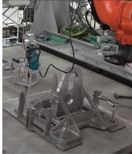
固定用ナットにて新規ラグ固定(ナットランナー)(1)
