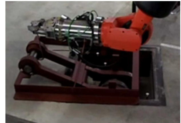
②⑥専用ラグピン用フックをラグピンに取付け
