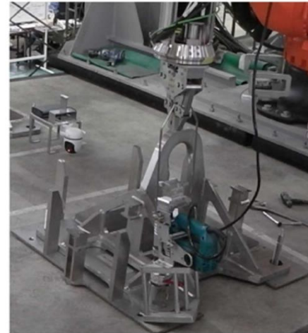
固定用ナットにて新規ラグ固定(ナットランナー)(4)
