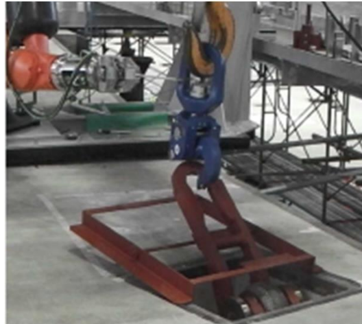
㉛オート開閉フックにて専用ラグピン用フックを把持
