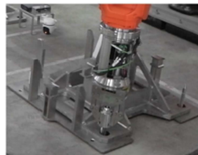
固定用ナットにて新規ラグ固定(グリッパツール)(2)
