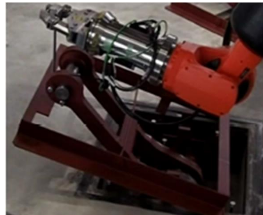
②⑤専用ラグピン用フックをラグピンに取付け
