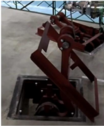
②④専用ラグピン用フックをラグ位置へ移動
