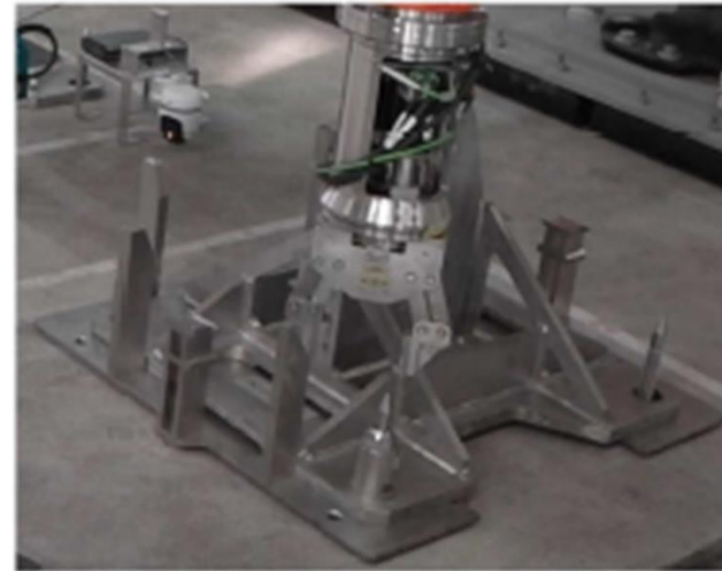
固定用ナットにて新規ラグ固定(グリッパツール)(4)
