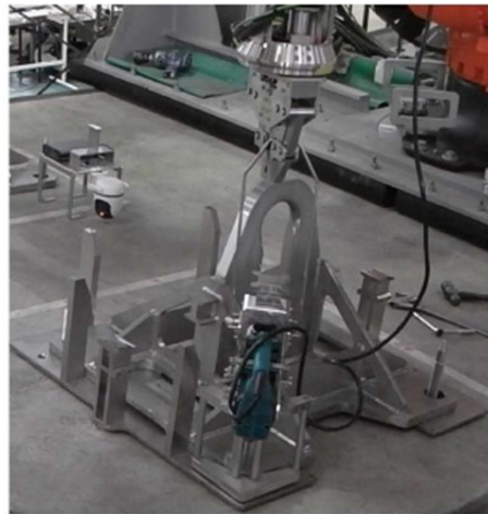
固定用ナットにて新規ラグ固定(ナットランナー)(3)
