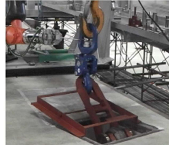
㉜オート開閉フックにて専用ラグピン用フックを把持
