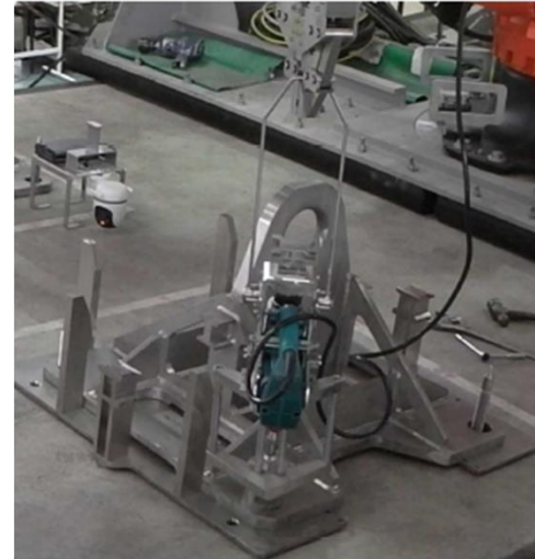
固定用ナットにて新規ラグ固定(ナットランナー)(2)
