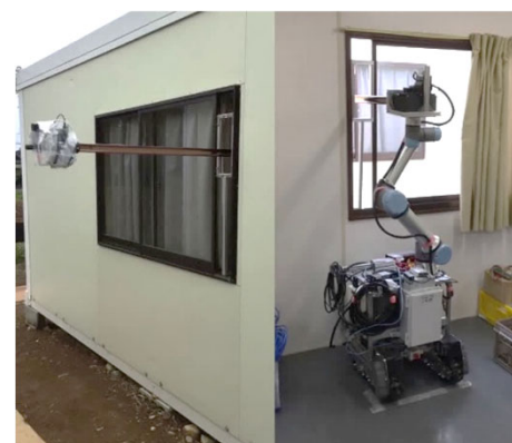
計測ユニットの伸縮動作 による安定性確認
