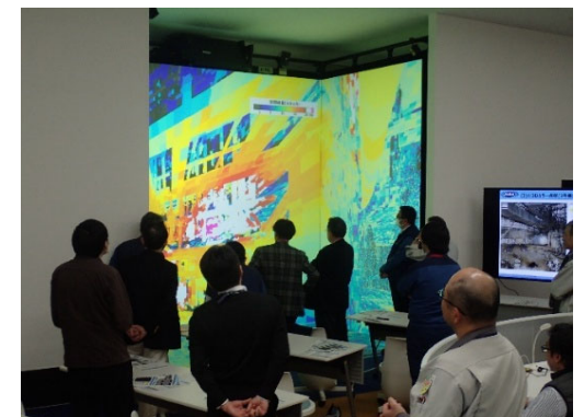
1F3号機の線量率マップ表示 (VRシステム)
