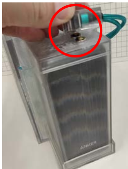
バッテリーは筐体内に入れ、ケーブルは赤丸部分にてマグネット脱着。
