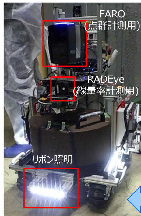
【実機:高所計測用台車ロボット】
